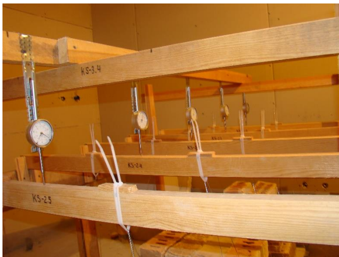
1.att. Koka siju modeļi: eksperiments ilgstošā slogojumā un deformētā elementa ģeometriskā shēma liecē.
